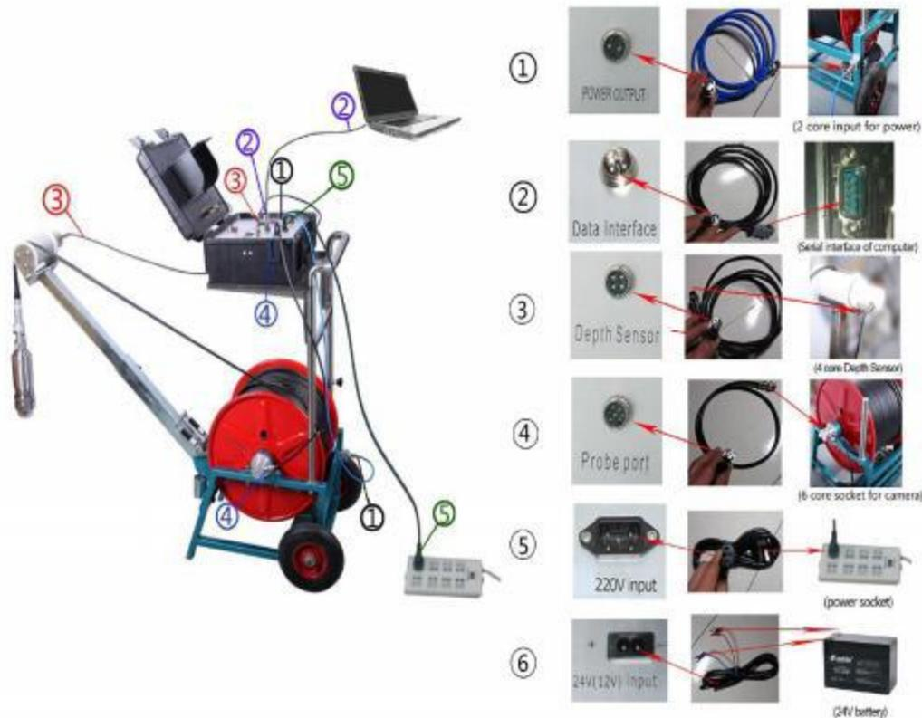
2.4.1) El cable de alimentación de la polea de profundidad es una línea de datos negra de cuatro núcleos, conectada a la interfaz de datos de la caja de control principal y la polea en la interfaz del "sensor de profundidad" y atornillada al pozo del tornillo.
