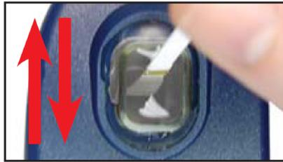
**NOTA: Mientras sumerja la tira de pruebas en la muestra, tenga cuidado de no salpicar ni botar la muestra desde la celda.** En mediciones de agua con temperaturas sobre los 35°C (ejemplo en hottubs o tinas calientes), retire la tira de pruebas de la celda cuando la pantalla muestre "10" o utilice el fotómetro calibrado especial SPAeXact.
