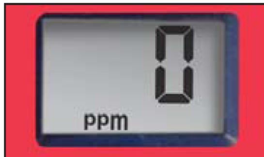
NOTA: En entornos de mucha luz, utilice la tapa para volver a cero y leer la medición.
