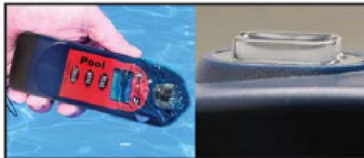
NOTA: Use el cepillo incluido con el tester para limpiar el tester antes y después de cada medición para evitar posibles interferencias de agentes externos en el muestreo y obtener resultados más exactos.
