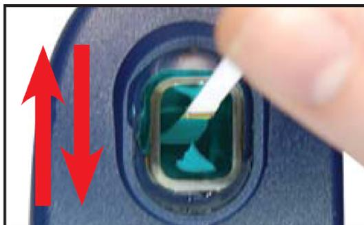
NOTA: **Mientras sumerja la tira de pruebas en la muestra, tenga cuidado de no salpicar ni botar la muestra desde la celda.** En mediciones de agua con temperaturas sobre los 35°C (ejemplo en hottubs o tinas calientes), retire la tira de pruebas de la celda cuando la pantalla muestre "10" o utilice el fotómetro calibrado especial SPAeXact.
