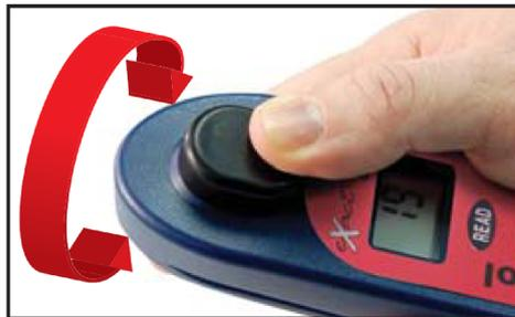
NOTA: En mediciones de agua con temperaturas sobre los 35°C (ejemplo en hottubs o tinas calientes), retire la tira de pruebas de la celda cuando la pantalla muestre "10" o utilice el fotómetro calibrado especial SPAeXact.
