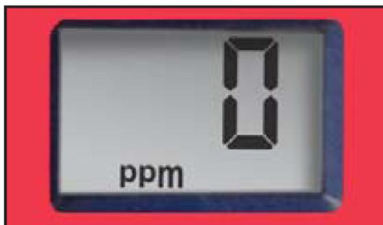
NOTA: En entornos de mucha luz, utilice la tapa para volver a cero y leer la medición.
