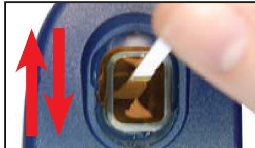
El DPD mancha la celda si se deja el producto en el aparato. Para evitar manchas, lave bien la celda y luego agregue 2 gotas de blanqueador (5-8%) y limpie con el cepillo hasta remover la mancha. Precaución: evite el contacto del blanqueador con los ojos y la ropa.
